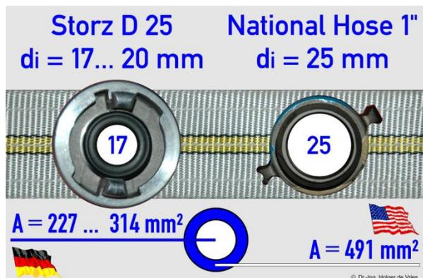
BILD A8.1 Der Nachteil deutscher D-Storz-Kupplungen liegt in der Halbierung der Querschnittsfläche im Bereich der Einbindestutzen und Dichtung.
