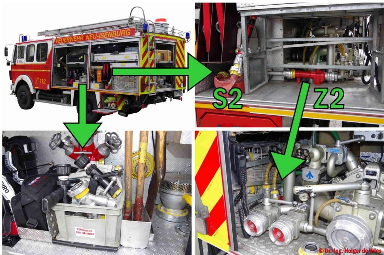
BILD A8.4 TLF 16/25 der FF Neu-Isenburg (LK Offenbach/HE) mit Schaumschnellgriff Z2-S2 und Systembox mit D-Schläuchen, Verteiler C-DCD, Strahlrohren D
