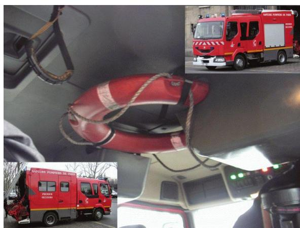
BILD A11.2 Rettungsring an der Decke der Mannschaftskabine eines LRF (Kombination aus "LF 10/10-St" und "RTW") der Feuerwehr Paris
