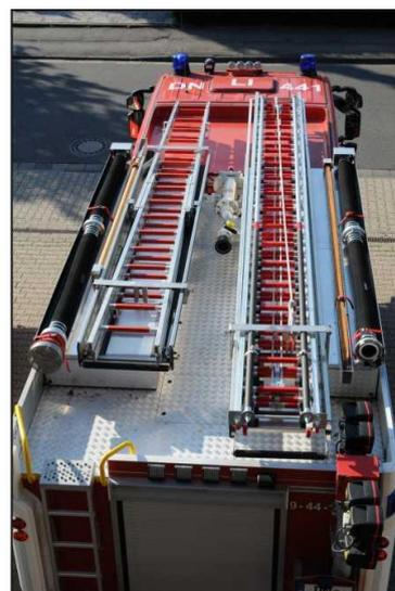
BILD A7.3 Saugleitung und Saugkorb vorgekuppelt verlastet auf Fahrzeugdach
