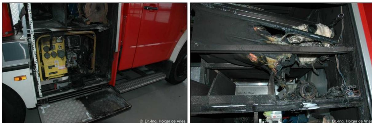
BILD 6.3 Brandschaden an einem Löschfahrzeug
