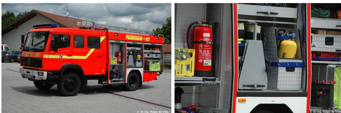
BILD A5.3 Die FF Vaterstetten (LK Ebersberg/BY) führt in ihrem TLF 16/25 (Baujahr 1998, Schlingmann) zusätzliche Atemschutzgeräte mit 9-L-Atemluftflaschen für ausgedehnte Objekte im Aufbau (G3) mit
