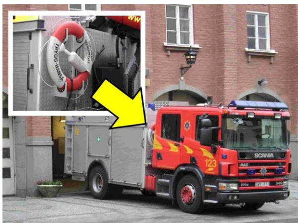
BILD A11.3 Bei der Feuerwehr Stockholm befindet sich zwischen Kabine und Gerätekoffer griffbereit ein Rettungsring
