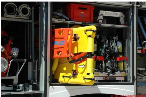
BILD A11.5 Unterbringung der Zusatzausstattung "Wasserrettung" in einem Löschfahrzeug (Ausführungsbeispiel)
