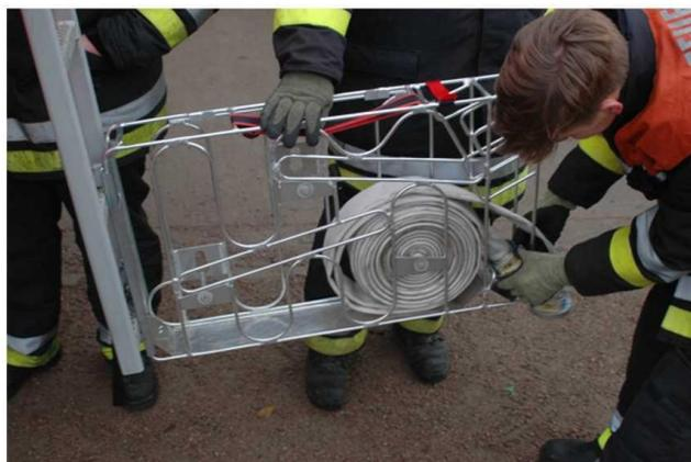
BILD 6.7 Schlauchwickelkorb C
