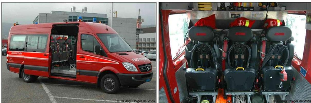
BILD A5.2 Fahrzeug der Betriebsfeuerwehr Novartis (CH) mit sechs Pressluftatmern mit 9-L-Compositeflaschen
